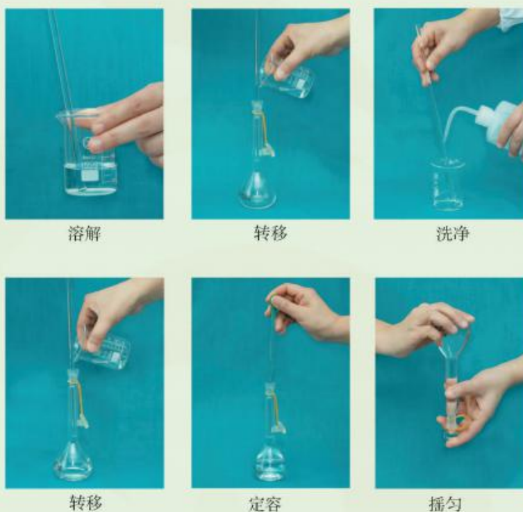
图 2-10 配制一定物质的量浓度的溶液
