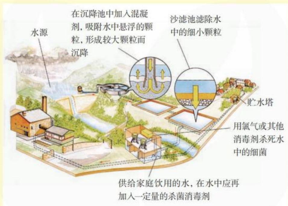
图2-23 自来水生产的一般过程
