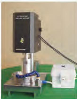
图 1-10 超声波钻孔机
