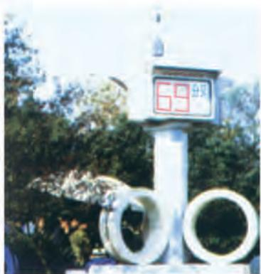
图 1-18 设置在街头的噪声监测仪
