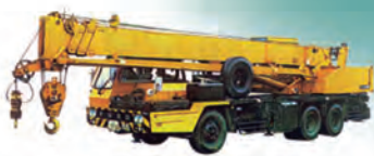
(d) 汽车起重机的功率可达 320 kW
