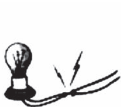
A. 导线的绝缘层破损
